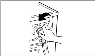
2. Den Wasserzulaufschlauch abschrauben.
