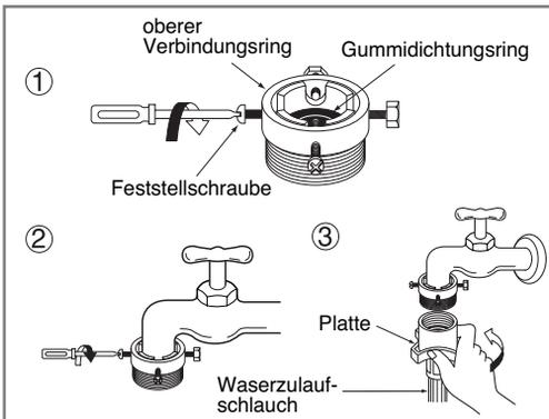
1. Lösen Sie den Feststeller und die vier Halteschrauben des Adapters.
