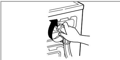
4. Den Wasserzulaufschlauch anschrauben.
