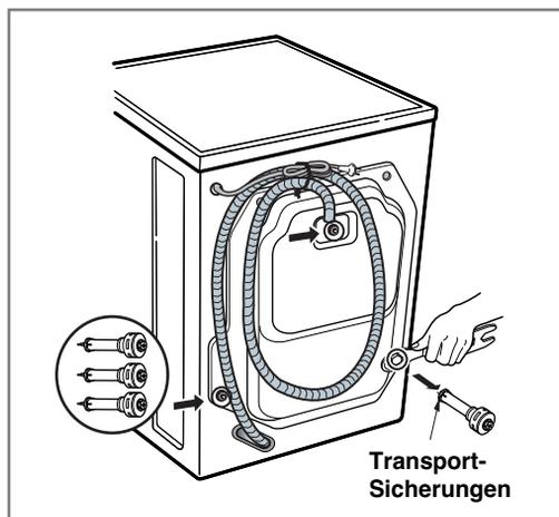
1. Die 3 Schrauben mit dem beiliegenden Schraubenschlüssel herausdrehen.
