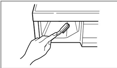
**3.** Konsole reinigen (z.B. mit Zahnbürste).
