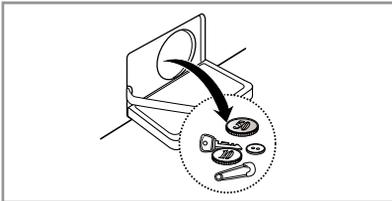
3. Entfernen Sie alle Fremdkörper aus dem Pumpenfilter.
