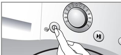
1. Betätigen Sie die Power Taste um die Waschmaschine einzuschalten. Betätigen Sie keine anderen Tasten oder drehen am Programmwahlschalter.
