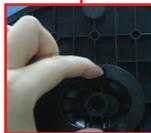
Quando desee desmontar el monitor del soporte, utilice una moneda para girar el tornillo en el sentido contrario de las agujas del reloj.
