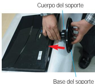
Utilice una moneda para apretar el tornillo de la parte trasera del soporte en el sentido de las agujas del reloj.
