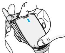
1. Positionnez les ergots situés au bas de la batterie dans les encoches prévues à cet effet.
