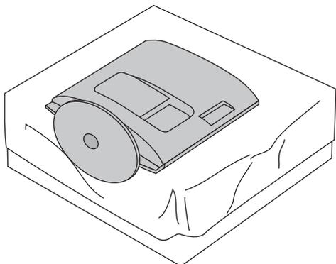
2 Extraiga el monitor de la Base del soporte girando el tornillo hacia la izquierda.
