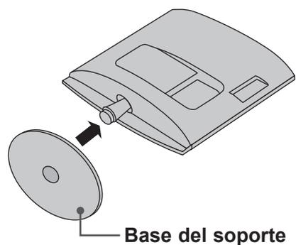
**3** Gire el bloqueo de la base del soporte 90° para fijar la base al cuerpo del soporte.
