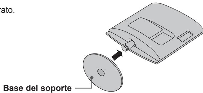
**3** Coloque una **Moneda** en la parte inferior de la base del pie y gire el tornillo hacia la derecha para apretarlo.
