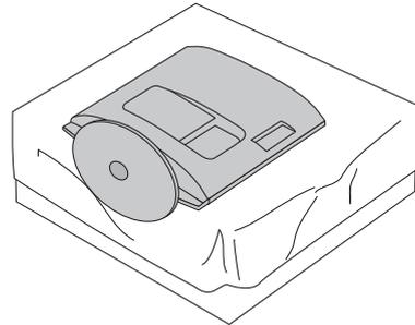
**2** Extraiga el monitor de la **Base del soporte** girando el tornillo hacia la izquierda. Gire el tornillo con ayuda de una **Moneda**.
