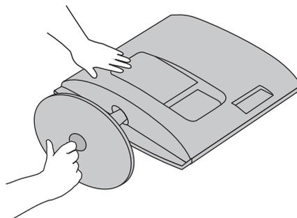
3 Gire el bloqueo de la base del soporte 90° para separar la base del cuerpo del soporte.
