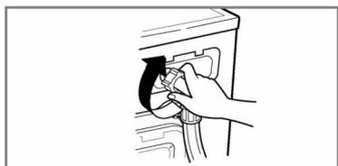
4. Resserrer le tuyau d'arrivée d'eau.
