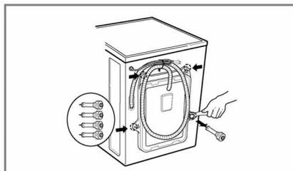
3. Enlever les 4 vis ainsi que les rondelles en caoutchouc en tordant légèrement la rondelle. Garder les 4 vis et la clé pour une utilisation future.
