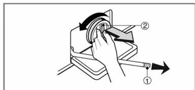
2. Retirer le bouchon de purge (1), laisser l'eau s'écouler. Utiliser un récipient pour empêcher l'eau de se répandre sur le sol. Lorsque l'eau ne s'écoule plus, dévisser le filtre de la pompe (2) en le faisant tourner vers la gauche.
