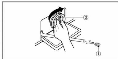
4. Après le nettoyage, faire tourner le filtre de la pompe (2) dans le sens des aiguilles d'une montre et insérer le bouchon de purge (1) pour le remettre en place. Fermer le capot.
