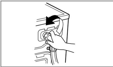
2. Den Wasserzulaufschlauch abschrauben.
