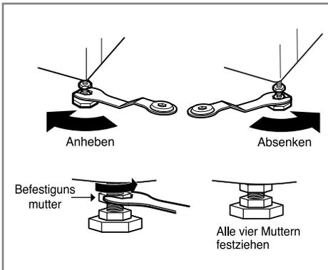
2. Bodenunebenheiten durch Drehen der Nivellierfüße ausgleichen (keinesfalls Holz usw. unter die Füße schieben). Sicherstellen, dass alle vier Füße den Boden berühren. Dann mit einer Wasserwaage sicherstellen, dass das Gerät waagrecht steht.
