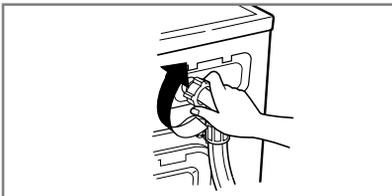
4. Den Wasserzulaufschlauch anschrauben.
