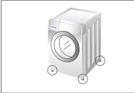
1. Das korrekte Nivellieren oder Ausrichten der Waschmaschine verhindert übermäßiges Geräusch und starke Vibration. Das Gerät auf festem, flachem Untergrund stellen - am besten in eine Ecke.
