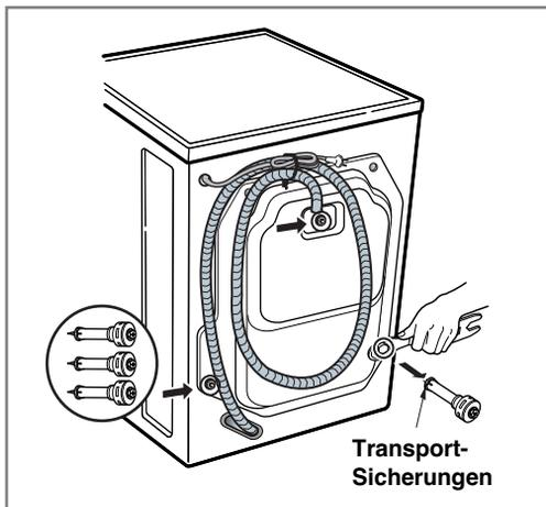
1. Die 3 Schrauben mit dem beiliegenden Schraubenschlüssel herausdrehen.
