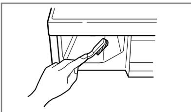
**3.** Schubladen-Fach reinigen (z.B. mit Zahnbürste).
