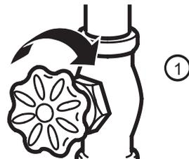
Abra el agua en la válvula de paso (2) y cierre después de haber drenado 1/4 de galón (1L) de agua.
