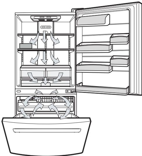
No bloquee ninguna de estas ventilas con paquetes de comida. Si las ventilas se bloquean, el flujo de aire se interrumpe, lo que puede ocasionar problemas de humedad.
