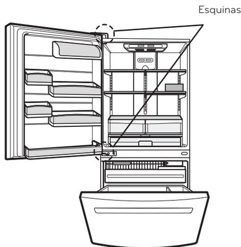
**NOTA:** Para facilitar la nivelación, haga que alguien levante un poco la parte superior del refrigerador; esto quitará algo de peso sobre los tornillos niveladores.
