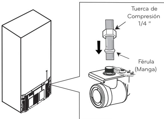
Apriete el tubo de conexión (casa) al sujetador de la parte trasera del refrigerador. Primero afloje el tornillo que sostiene el sujetador. Después, inserte el tubo de conexión de casa en el orificio. Finalmente, vuelva a apretar el tornillo.
