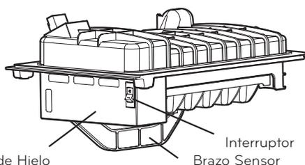
La fábrica de hielos produce 12 cubos por ciclo (entre 80 y 100 cubos en un período de 24 horas, dependiendo de la temperatura del compartimento del congelador, número de veces en las que se abre la puerta y otras condiciones de uso).
