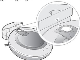
1. Methode. Führen Sie den HOM-BOT mit den beiden Pfeilen am HOM-BOT auf die Pfeile in der Ladestation ausgerichtet in die Ladestation ein. Es erklingt eine Tonfolge und der Ladevorgang startet.
