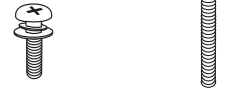
ברגים למעמד 3 EA M5 x 16 (ראה עמ' 14) 4 EA M4 x 30 (ראה עמ' 14~15)
