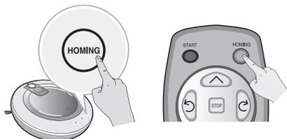
Méthode 2. Si vous appuyez sur la touche 'HOMING' de la télécommande ou le bouton 'HOMING' de l'aspirateur robot, le chargement démarrera par un retour automatique de l'aspirateur robot vers la base de chargement avec la voie de recherche.
