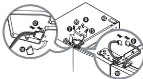
7. Mueva el asa independiente de la puerta 1 hacia la derecha y fije el tornillo 3 en la posición derecha para acoplar la cubierta de la puerta 2. Mueva la cubierta de la puerta 4 de la derecha hacia la izquierda y fjela. Coloque el asa de la puerta del congelador 2 siguiendo los mismos pasos que con el asa de la puerta del frigorífico 1.
