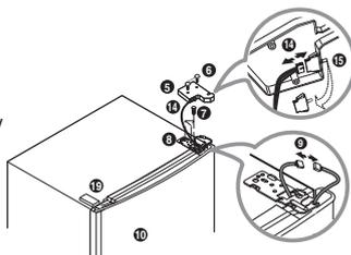
3. Tras separar la tapadera superior izquierda ⑪ de la puerta separada del frigorífico ⑩, extraiga con cuidado la tapa superior ⑫ y tire del cable ⑬ para conectarlo al orificio de la izquierda. Coloque el tapón superior separado ⑫ en la posición normal y coloque el tapón ⑪ en el orificio de cables de la derecha. Afloje el tornillo ⑳ ㉔ bajo la puerta del compartimento frío ⑩, muévelo a la izquierda del retén ㉑ ㉓ y, a continuación, conéctelo.
