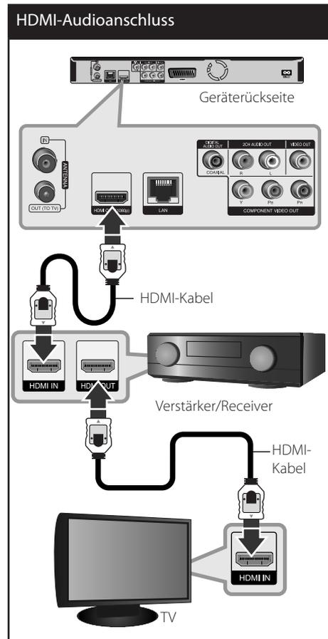
Falls Ihr Verstärker eine HDMI-Ausgangsbuchse besitzt, verbinden Sie diese Buchse über ein HDMI-Kabel mit der HDMI-Eingangsbuchse am Fernsehgerät.
