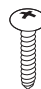
Skrutky stojana 8EA, M4 x 20 (pozrite si str. A-3, A-4, A-5, A-6)
