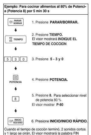
NOTA: Si usted no selecciona nivel de Potencia, el horno operará en potencia HIGH (alta). Para vovler a fijar Potencia Alta de cocción, siga los pasos 4 y 5 mostrados arriba.
