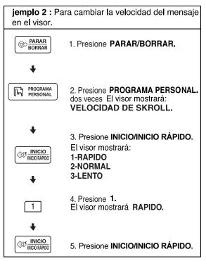
NOTA: Para cambiar la velocidad del mensaje del visor repita los pasos 1-5.
