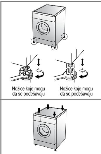
2. Ukoliko je potrebno izvršite nivelisanje mašine uz pomoć nožica, kao što se vidi na ilustracijama (nemojte umesto toga podmetati nešto drugo, kao što su parčići drveta, ispod nožica). Uverite se da mašina na sve četiri nožice stoji stabilno pre nego što je uključite (iskoristite libelu za proveru).
