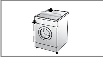
1. Pravilnim nivelisanjem mašine sprečićete nastanak buke i vibracija. Instalirajte mašinu na mesto koje ima ravnu i čvrstu podlogu, najbolje u ugao prostorije.
