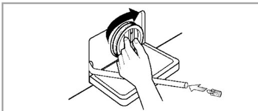
4. Nakon čišćenja okrenite pumpu filtera do kraja nadesno kako bi se poklopile bele linije filtera i kućišta pumpe. Zatim umetnite ispusni priključak u crevo.
