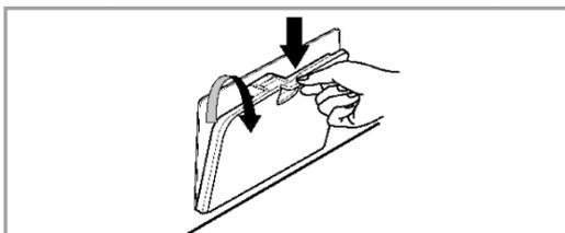
1. Otvorite vrata na prednjoj oplati mašine i odšrafite te čep odvodnog creva.
