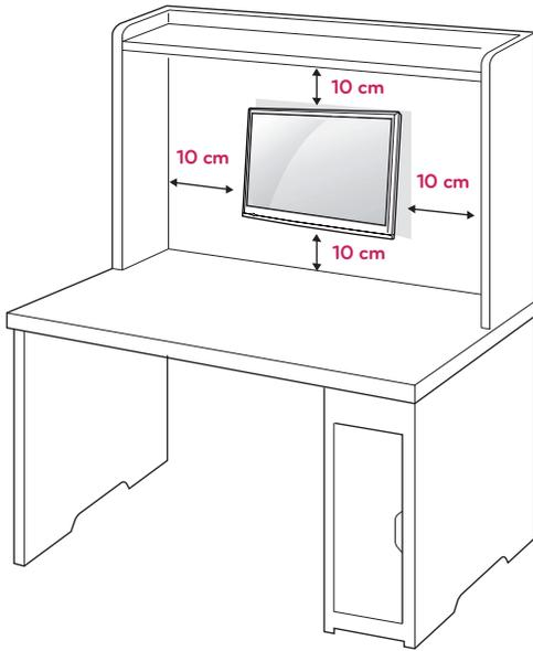
Si tiene intención de montar la TV en la pared, fije el accesorio de montaje en pared (piezas opcionales) a la parte posterior de la TV. Si instala la TV mediante el accesorio de montaje en pared (piezas opcionales), fíjela con cuidado para que no se caiga.
