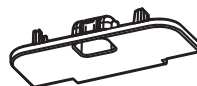
Sienas montāžas iekšējās starplikas 4 EA (tikai modelim 32/37/42/47/55LM61**, 32/42/47LM58**, 32/37/42/47LS56**) (sk. 20. lpp.)
