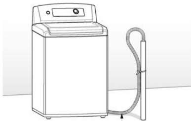
Manguera de drenaje
