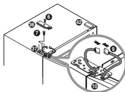
8. Déplacez la poignée de la porte séparée 1 vers la droite et fixez la vis 3 dans la position correcte pour rattacher le capuchon de la porte 2. Déplacez le capuchon de la porte 41 du côté droit vers le gauche et rattachez-le. Rattachez la poignée de la porte du congélateur 2 de la même façon que pour la poignée de la porte du réfrigérateur 1.
