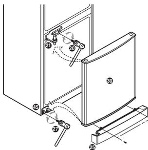
7. Après avoir assemblé la porte en alignant l'orifice de la charnière au bas de la porte du réfrigérateur 10 et l'axe de la charnière du milieu 21, sortez la charnière supérieure gauche 36 et la charnière gauche 37 du sac. Après avoir branché le câble 9, serrez le bouton 7 et vissez la vis 6 au capot de la charnière de gauche 36. Sortez le capot de droite 42 du sac, nettoyez le fil et installez-le sur le côté droit du dessus du réfrigérateur.
