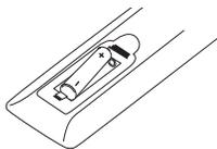
Retirez le couvercle du compartiment de la pile à l'arrière de la télécommande, puis insérez une pile AAA en respectant la polarité **+** et **-**.
