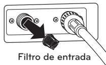
Filtro de entrada
