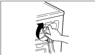
4. Den Wasserzulaufschlauch anschrauben.
