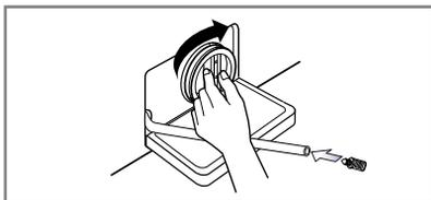
4. Nach der Säuberung drehen Sie den Pumpenfilter wieder ein.
