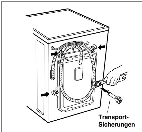
1. Die 4 Schrauben mit dem beiliegenden Schraubenschlüssel herausdrehen.
