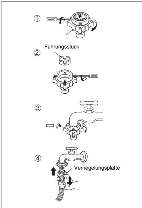
1. Lösen Sie den Feststeller und die vier Halteschrauben des Adapters.
