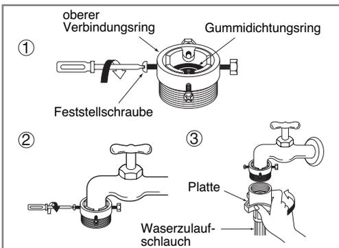
1. Lösen Sie den Feststeller und die vier Halteschrauben des Adapters.
