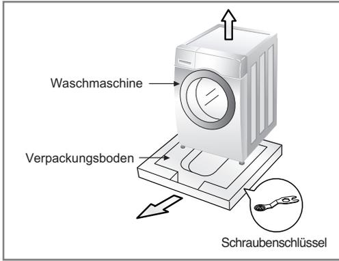
1. Entfernen Sie den Verpackungskarton und das Styropormaterial.
