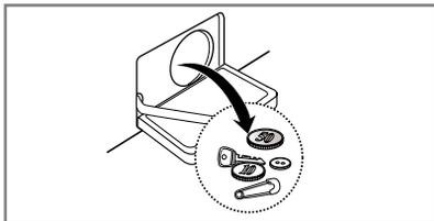
3. Entfernen Sie alle Fremdkörper aus dem Pumpenfilter.
