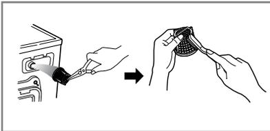
3. Den Filter mit einer harten Bürste reinigen.
