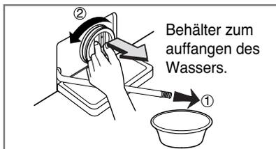
2. Öffnen Sie dann den Filter, indem Sie ihn nach links drehen.
