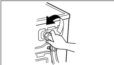
2. Den Wasserzulaufschlauch abschrauben.
