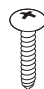
Állvány csavarja 8EA, M4 x 20 (lásd az A-3, A-4, A-5, A-6 oldalon)
