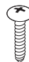
Zavrtnji za postolje 8EA, M4 x 20 (pogledajte strane A-3, A-4, A-5, A-6)
