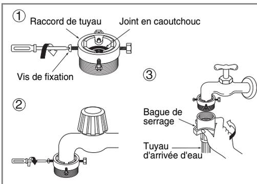
1. Dévissez la bague de serrage et les 4 vis de fixation.
