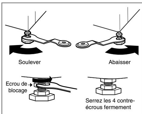
2. Si le sol est inégal, régler les pieds de mise à niveau (ne pas insérer de cales de bois, etc ... sous les pieds). S'assurer que les quatre pieds sont stables et reposent sur le sol. Vérifier ensuite que l'appareil est parfaitement à niveau (utiliser un niveau à bulle d'air).
