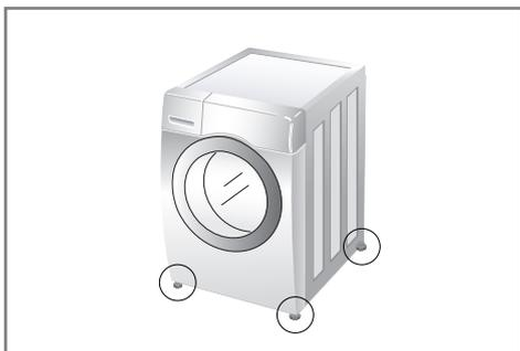
1. Pour réduire les vibrations et les bruits excessifs, installez le lave-linge sur un sol stable et à niveau, de préférence dans un coin de la pièce.
