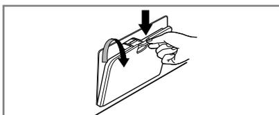
1. Ouvrez la trappe d'accès en positionnant en-dessous un récipient qui collecte l'eau s'en écoulant. Tirez le tuyau.
