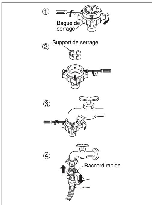
1. Dévissez la bague de serrage de l'adaptateur et les 4 vis de fixation de l'adaptateur.
