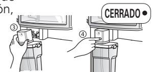
**ANOTACIÓN:** Si el depósito no está introducido adecuadamente, el agua goteará de la boquilla en el cesto de la puerta. Espere siempre 15 segundos después de haber dispensado agua, antes de extraer la botella de agua para rellenar o limpiar.
