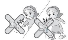
Elimine el agua o el polvo del enchufe de alimentación e introdúzcalo con los extremos de las clavijas correctamente conectados.
