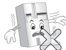
No introduzca las manos ni barras de metal en la salida de refrigeración, en la cubierta, en la parte inferior del refrigerador, o en la rejilla de ventilación de la parte posterior. Podría provocar descargas eléctricas o daños.
