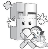
**Transporte el refrigerador con el tirador hacia arriba y la parte inferior hacia abajo.**
