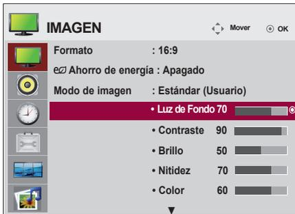
**Luz de Fondo** : permite controlar el brillo de la pantalla y ajustar el brillo del panel LCD.
