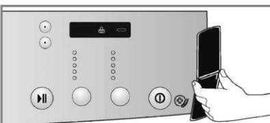
2. Kada od Vas to zatraži pozivni centar, smjestite mikrofon mobitela vrlo blizu komandi za paljenje/gašenje.
