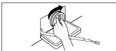
4. Nakon čišćenja stavite na mjesto filter i vratite odlivni čep.
