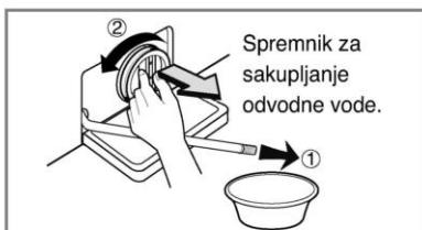
2. Izvucite čep. Za vađenje filtra, odvijte na lijevu stranu.
