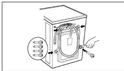
3. Izvadite 4 vijke zajedno s gumenim omotačima lagano okrećući omotač. Sačuvajte 4 vijke i zatezni ključ za buduću potrebu.
