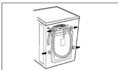
1. Da bi se spriječila unutrašnja oštećenja, zategnuta su 4 posebna vijka. Prije puštanja u rad perilice, uklonite vijke zajedno s gumenim omotačima.
