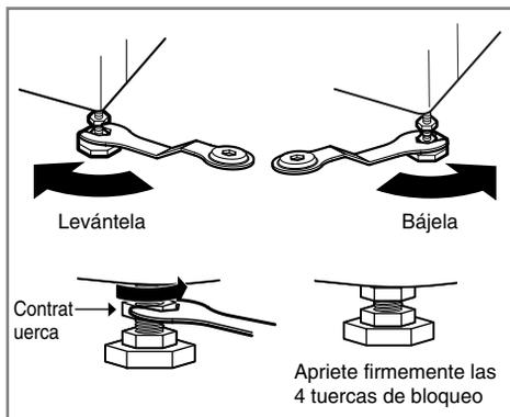
2. Si el suelo no está nivelado, ajuste los pies de nivelación según sea necesario (no introduzca trozos de madera, etc. debajo de los pies). Asegúrese de que los cuatro pies son estables y descansan sobre el suelo y, a continuación, compruebe que el electrodoméstico está perfectamente nivelado (utilice un nivel de burbuja de aire).
