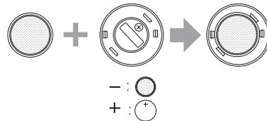
3. Remplacez le couvercle du compartiment des piles sur la télécommande et faites-le pivoter dans le sens horaire pour le fermer.
