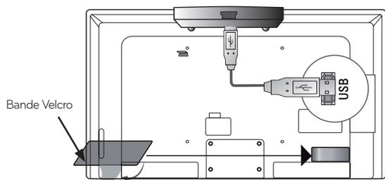
\* Fixez la clé électronique RF en l'alignant avec le coin supérieur gauche du support.
