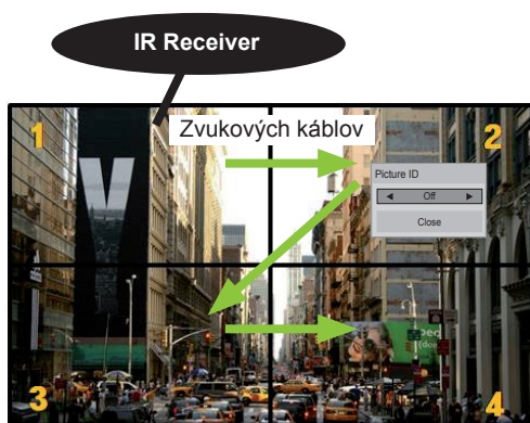
Zobrazenie na viacerých televízoroch 2 x 2 (celkový počet identifikátorov televízorov: 4) Priradené identifikátory televízorov sú znázornené na obrázku.
