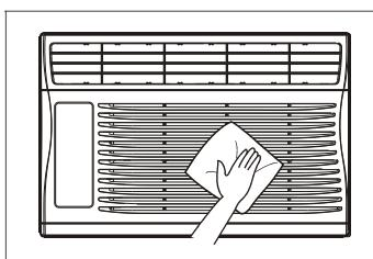
Para asegurarse una eficiencia continua, las bobinas del condensador (del lado expuesto al exterior) debe ser revisado y lavado periódicamente sea por que se tranque con basura o polvo de la atmosférica.
