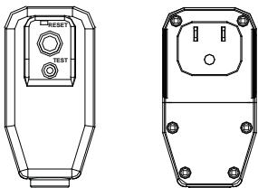
El cable de alimentación puede incluir un dispositivo interruptor de corriente. La carcasa del enchufe cuenta con un botón de prueba y otro de reinicio. El dispositivo debe comprobarse periódicamente presionando primero el botón **TEST** y después **RESET**. Si el botón **TEST** no se desconecta o si el botón **RESET** no permanece activo, suspenda el uso del aire acondicionado y póngase en contacto con un técnico de servicio cualificado.
