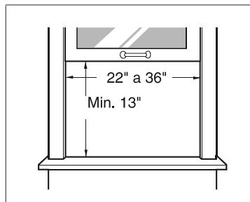
**ADVERTENCIA :** Este producto es un aparato de AIRE ACONDICIONADO PARA INSTALACIÓN EN VENTANAS. Como tal, se necesita una ventana de un cuelgue o de doble cuelgue para una instalación adecuada. No se recomiendan instalaciones en lugares que no sean ventanas, utilizando casquillos, orificios en las paredes ni cualquier otro tipo.
