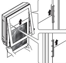
9. Вдвиньте оба соединительных штифта, находящиеся в нижней части панели, до фиксации. Затем включите изделие.
