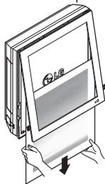
5. Переверните изображение лицевой стороной вниз вместе с рамой, затем снимите предохранительную ленту, наклеиваемую на раму.
