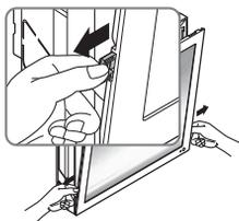
3. Толкните и закройте переднюю панель изделия вверх, затем потяните нижнюю часть передней панели вперед до фиксации.
