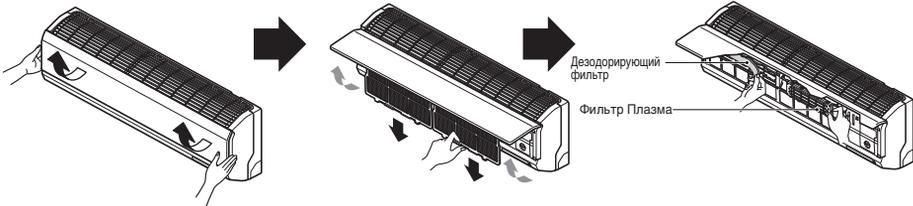
**Система 2 :** Потяните переднюю панель с обеих сторон как показано на рисунке. Затем потяните за петлю фильтра слегка вперед, чтобы извлечь фильтр. После извлечения воздушного фильтра извлеките пламенный и тройной дезодорирующий фильтры, слегка потянув вперед.
