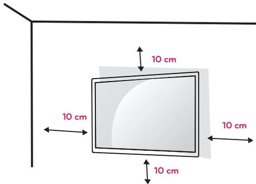
Si vous avez l'intention d'installer le téléviseur sur un mur, fixez l'interface de la fixation murale (pièces optionnelles) à l'arrière de l'appareil. Quand vous installez le téléviseur en utilisant l'interface de fixation murale (pièces optionnelles), fixez-la soigneusement pour qu'elle ne tombe pas.
