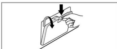
1. Ouvrez la trappe d'accès en positionnant en-dessous un récipient qui collecte l'eau s'en écoulant. Tirez le tuyau.
