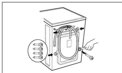
3. Enlever les 4 vis ainsi que les rondelles en caoutchouc en tordant légèrement la rondelle. Garder les 4 vis et la clé pour une utilisation future.
