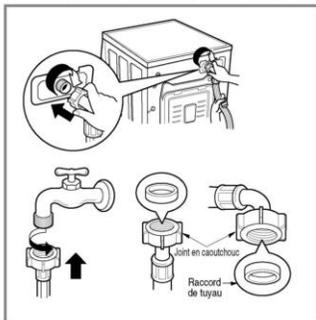
► La pression d'alimentation d'eau doit être comprise entre 100kPa et 1000kPa (1,0~10kgf/cm<sup>2</sup>).
