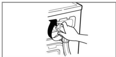
4. Resserrer le tuyau d'arrivée d'eau.
