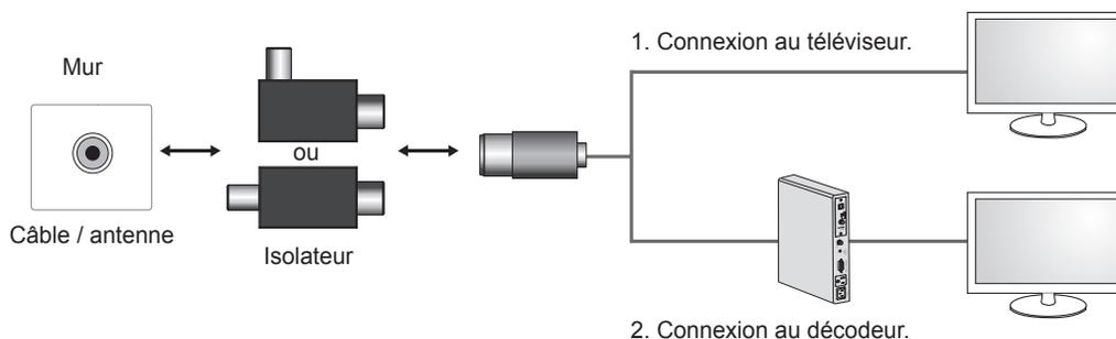
Connectez l'une des extrémités de l'isolateur au câble ou à la prise de l'antenne et l'autre extrémité au moniteur ou au décodeur.
