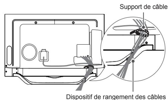
Rassemblez les câbles et passez-les dans l'attache plastique.
