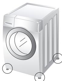
1. Un corretto livellamento della lavatrice serve a impedire che si producano vibrazioni e rumori eccessivi. Installare la macchina su un pavimento ben livellato e compatto, preferibilmente in un angolo della stanza.
