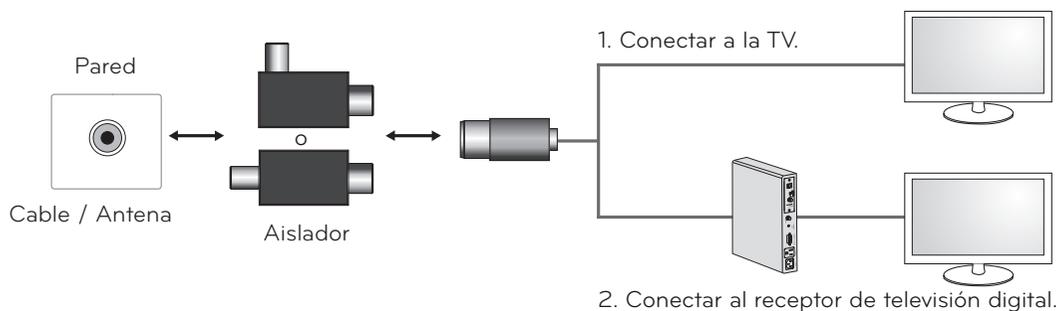
Conecte un extremo del aislador a la toma de cable/antena y el otro a la TV o receptor de televisión digital.
