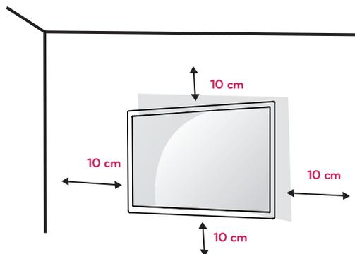
Si tiene intención de montar la TV en la pared, fije el accesorio de montaje en pared (piezas opcionales) a la parte posterior de la TV. Si instala la TV mediante el accesorio de montaje en pared (piezas opcionales), fijela con cuidado para que no se caiga.
