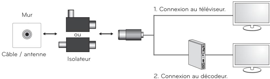
Connectez l'une des extrémités de l'isolateur au câble ou à la prise de l'antenne et l'autre extrémité au téléviseur ou au décodeur.
