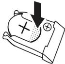
3. Drehen Sie das Batteriegehäuse um und legen Sie eine neue Batterie mit der Polung (+) zur Markierung (+) am Batteriegehäuse zeigend ein. Drücken Sie die Batterie vorsichtig hinein.
