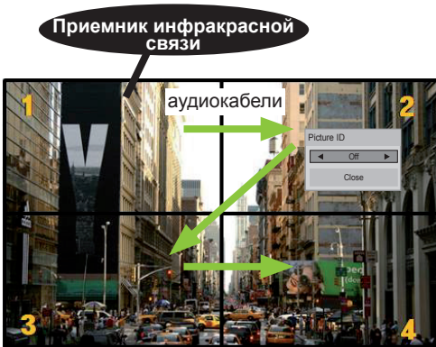
Мультикартинка 2X2 (всего идентификаторов устройств: 4) Идентификаторы устройств назначаются, как показано на картинке.
