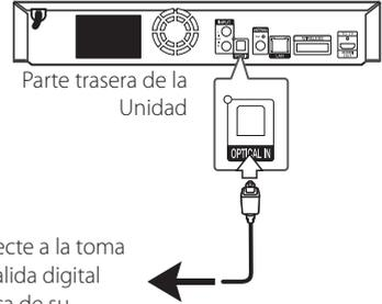
Conecte a la toma de salida digital óptica de su componente.
