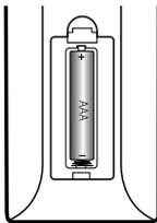
Quite la cubierta de la batería en la parte trasera del Control Remoto e inserte una batería (tamaño AAA) de 1,5 Vcc en donde  $\oplus$  y  $\ominus$  estén colocados correctamente.
