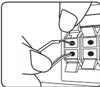
Conecte la tira negra de cada cable a los terminales marcados con – (menos) y el otro extremo a los terminales marcados con + (más).
