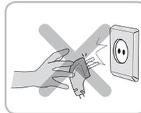
Beim Trennen der Stromversorgung immer direkt am Stecker und nicht am Kabel ziehen. Beim Ziehen des Steckers nicht die Stifte mit den Fingern berühren.
