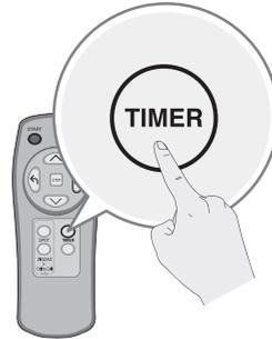
2. Stellen Sie durch entsprechend häufiges Drücken der TIMER-Taste die Zeit ein. Jedes Drücken erhöht die Startzeit.
