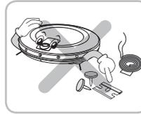
Der HomBot darf keine Flüssigkeiten, Klängen, Reißnägeln, Späne etc. aufsaugen.
