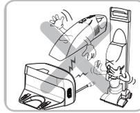
Den HomBot niemals mit einer Batterie und/oder einer Ladestation eines anderen Herstellers verwenden.
