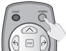
Methode 2. Wird die HOMING-Taste der Fernbedienung oder des HomBot gedrückt, ertönt ein Ton und der HomBot kehrt zur Ladestation zum automatischen Wiederaufladen zurück.
