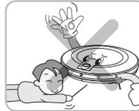
Keine scharfkantigen Gegenstände in die Öffnung des Ultraschallsensors des HomBot stecken.
