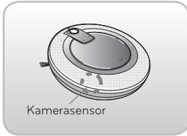
Über den Sensor der Kamera unter dem HomBot werden Bilder vom Boden erfasst. Dadurch wird der Standort des HomBot bestätigt und jeder Teil des Raumes kann gründlich gereinigt werden.
