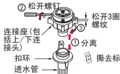
分离连接座和进水管，松开螺钉，下连接头松开3圈螺纹
