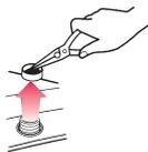
3 用牙刷将滤网上的污物去除，并重新插回进水阀。
