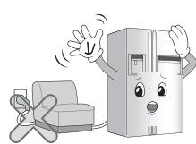
**لا تمدد أو تعدل طول قابس التيار الكهربائي.**
