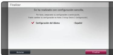
Oprima **ENTER** (⊙) mientras está encendido [Finalizar] para finalizar la configuración inicial. Si desea cambiar la configuración, utilice **a/d** para seleccionar [Anterior] y oprima **ENTER** (⊙).
