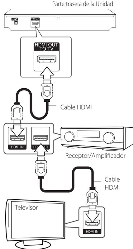
Conecte la toma de salida HDMI del amplificador a la toma de entrada de su televisor usando un cable HDMI si su amplificador tiene toma de salida HDMI.
