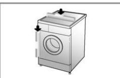
1. Pour réduire les vibrations et les bruits excessifs, installer la machine sur un sol stable et à niveau, de préférence dans un coin de la pièce.
