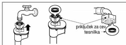
**OPOMBA** Ko ste končali s priključevanjem in ste ugotovili, da vodo pušča iz cevi, ponovite vse korake. Uporabite pri tem najbolj običajen tip pipe za dotok vode. V primeru, da je pipa oglata ali prevelika, odstranite vložni obroč preden vstavite pipo v adapterja.
