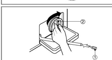
4. Drehen Sie den Pumpenfilter nach der Reinigung ganz bis zum Ende, bis die weißen Linien auf dem Filter und dem Pumpengehäuse aufeinandertreffen. Fügen Sie dann die Ablassschraube in den Schlauch ein.
