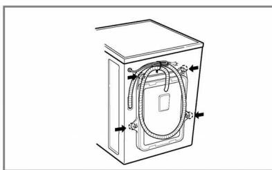
1. Vijaki so bili nameščeni, da preprečijo poškodovanje stroja med transportom. Pred uporabo odmaknite vijke na gumijastih navojnih ploščicah.
