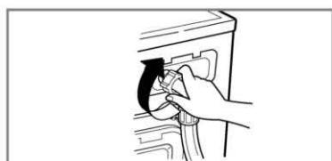
4. Resserrer le tuyau d'arrivée d'eau.
