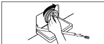
4. Après le nettoyage, tournez le filtre de la pompe vers la droite jusqu'au bout pour que les traits blancs du filtre et du corps de la pompe se rencontrent. Introduisez ensuite le bouchon de vidange sur le tuyau.
