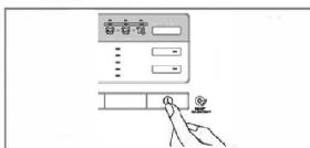
1. Pritisnite gumb za vklop/izklop in pralni stroj vključite. Ne pritisnite nobenega drugega gumba in ne zavrtite gumba za izbiro programa.
