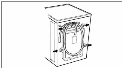
1. Das Gerät ist durch 4 Spezialschrauben gesichert, um Transportschäden zu verhindern.
