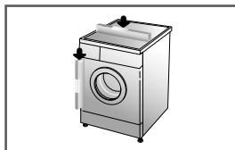
1. Un corretto livellamento della lavatrice serve a impedire che si producano vibrazioni e rumori eccessivi. Installare la macchina su un pavimento ben livellato e compatto, preferibilmente in un angolo della stanza.
