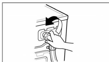
2. Den Wasserzulaufschlauch abschrauben.
