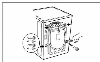
3. Vzemite ven 4 vijke vzdolž gumijaste plošče z rahlim odvijanjem. Obdržite vijke in ključ za kasnejšo uporabo. Kadar se ta stroj transportira, je treba te vijke ponovno namestiti.
