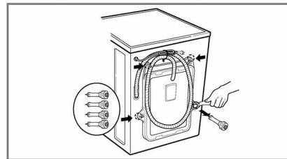
3. Die 4 Schrauben lösen und die Gummipropfen etwas drehen, um sie zusammen mit den Schrauben abzunehmen. Die 4 Schrauben und den Schraubenschlüssel für späteren Gebrauch aufbewahren.
