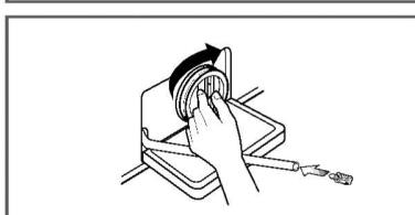
4. Filter črpalke po čiščenju obrnite do konca v desno, da se stakneta beli črti na filtru in ohišju črpalke. Nato vtaknite čep v cev.
