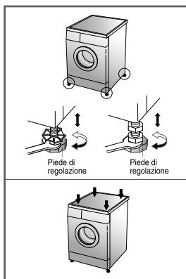
2. Se il pavimento non è uniforme, regolare il piede di regolazione secondo necessità (non inserire spessori di nessun tipo sotto i piedi della macchina).
