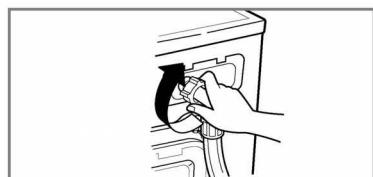
4. Den Wasserzulaufschlauch abschrauben.
