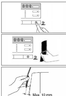
1. Betätigen Sie die Power Taste um die Waschmaschine einzuschalten. Betätigen Sie keine anderen Tasten oder drehen am Programmwalhschalter.
