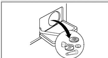
3. Fremdkörper aus dem Pumpenfilter (②) entfernen.
