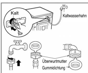
► Diese Maschine ist auf einen Wasserdruck von 100 kPa bis 1000 kPa (1,0 – 10 kgf/cm<sup>2</sup>) ausgelegt.
