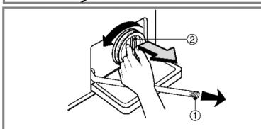
2. Den Ablaufstopfen (①) entfernen, um das Wasser abfließen zu lassen. Davor eine Schüssel o.ä. unterstellen, damit kein Wasser auf den Boden fließt. Wenn kein Wasser mehr ausfließt, den Pumpenfilter (②) nach links drehen und öffnen.
