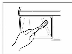
\* Entfernen Sie Flecken in der Trommel mit Edelstahlreiniger.
