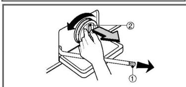
2. Preden odprete odtočni zamašek (①) postavite pod njo pososodo. Tako preprečite izliv vode na tla. Odprite počasi zamašek in pustite, da voda steče ven. Ko voda ne teče več, obrnite filter črpalke (②) na levo.
