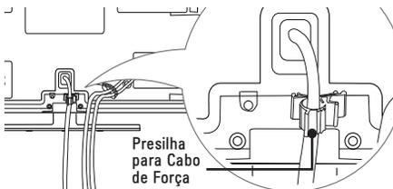
2. Em seguida use a presilha de cabos para organizar os cabos de conexão.
