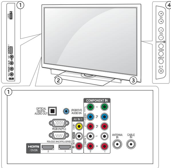
① Painel lateral e traseiro de conexões. Detalhes na seção Conectar.
