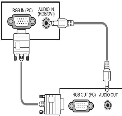
3. Após a conexão ligue os aparelhos. Na TV pressione **INPUT** e selecione a conexão **RGB**.
