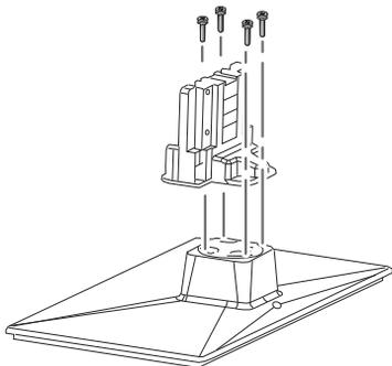
2. Após fixar o **SUPORTE**, use os **PARAFUSOS** para fixar a **BASE** à TV.
