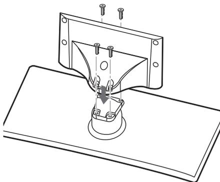
2. Após fixar o **SUPORTE**, use os **PARAFUSOS** para fixar a **BASE** à TV.
