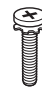
Vis pour support de type étagère 3EA, M4 x L10 (Uniquement LB51**) (Voir p.20)
